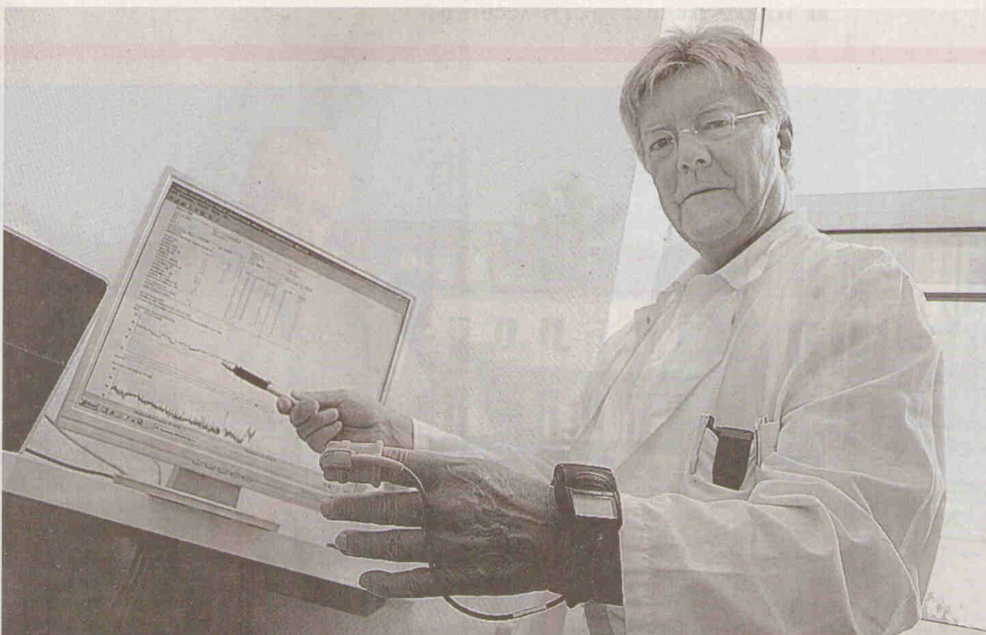
Probetrieb: Dr. Wilfried Böhning demonstriert am Testgerät, wie der Sensor wird auf den Finger gesteckt und die Daten auf den Empfänger am Handgelenk übertragen werden. Anschließend können die Ergebnisse auf einem Rechner ausgewertet werden. FOTO: HEIKO APPELBAUM
